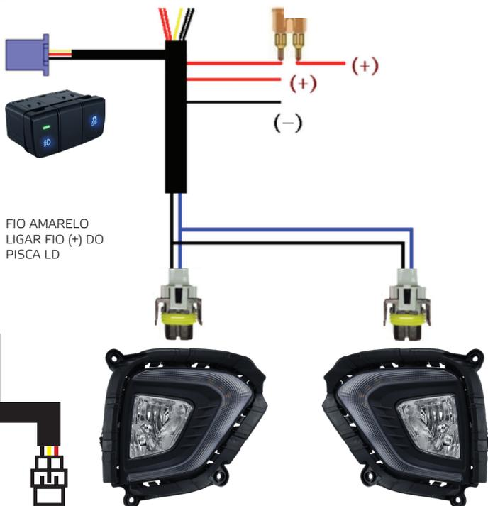
**ATENÇÃO:** Não utilizar em hipótese alguma, lâmpadas de **H11 55W** (risco de incêndio). Produto fabricado de acordo com os padrões originais.
