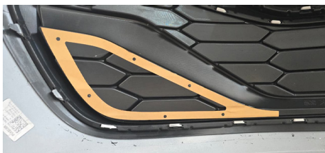
IMAGEM 2 - COLAR O GABARITO QUE ACOMPANHA O KIT DENTRO DA EMBALAGEM, RECORTAR CONFORME A MARCAÇÃO. (RECOMENDAMOS O USO DE UM SOPRADOR TÉRMICO E UM ESTILETE PARA O RECORTE)
