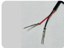
Após passar os cabos pelas portas, painéis, console, conecte cada tomada nas centrais e faça a ligação elétrica através do fio de lanterna ou pós chave fio vermelho (+) e Preto (-)
