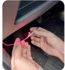
Conecte a fibra ótica ao canhão de luz e aperte o parafuso plástico com cuidado.
