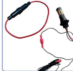
Conectar o terminal do fio fornecido no kit, nas lâmpadas conforme a imagem, depois conectar no sinal pós chave 12V (utilizar porta fusível que acompanha o kit), para o funcionamento do DRL.
