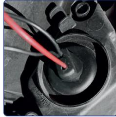
Encaixar o soquete de borracha do DRL DUAL COLOR no lugar do soquete da seta original do veículo conforme imagem.
