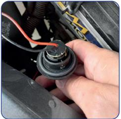
Faça a conexão do plug com base SLL-DC1156 ou SLL-DC7440 (de acordo com o modelo do seu veículo)
