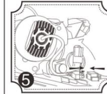
Conecte o cabo de energia no conector original do carro
